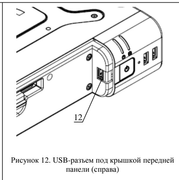
Рисунок 12. USB-разъем под крышкой передней панели (справа)
