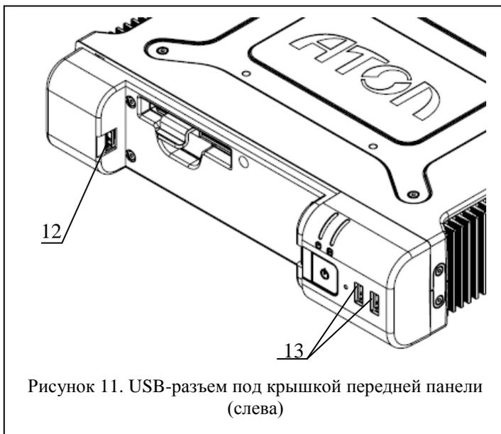
Рисунок 11. USB-разъем под крышкой передней панели (слева)
